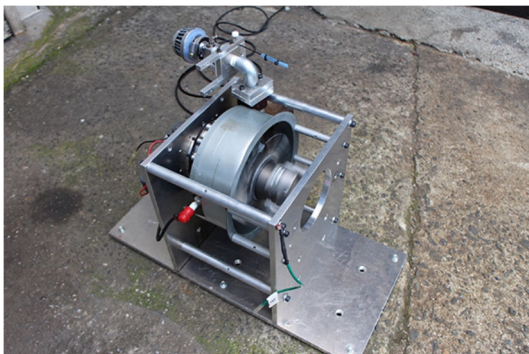
▲水素での運転中の80cc RE REの先端に発電機用ジェネレータやポンプ等を取付けて原動機として使用。
